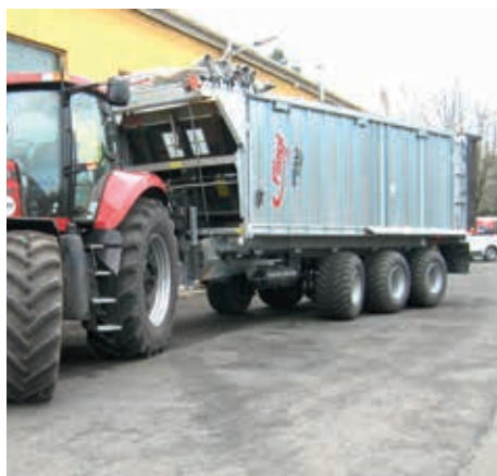
▲ A nagy teherbírású pótkocsik kormányzott tridem tengelyes futóművei következtében kisebb vonóhorog teljesítménnyel üzemeltethetők
