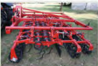
Kombi-Mix magágykészítők 2,8-tól 5,6 m munkaszélességig, robosztus kivitel.
