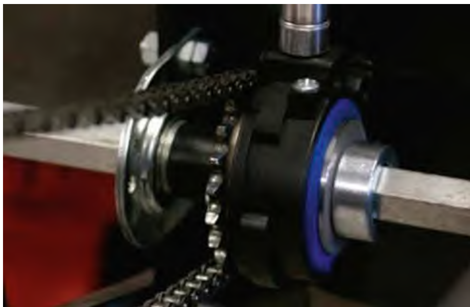
↑ 3. kép: pneumatikus kuplung a vetőtengelyen
