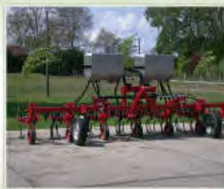
Calderoni FPS oldalazó talajmaró gyűmölcsösbe. Maximális kinyúlás traktorközéptől 310 cm.
