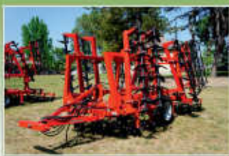
SA ásóboronák 1,8-től 8,4 m munkaszélességig, 3 sor késtengellyel, 2 sor törőhengerrel, bóracél ásókésekkel, öntvény csapággal szerelve.
