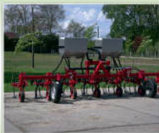
Calderoni FPS oldalazó talajmaró gyűmölcsösbe. Maximális kinyúlás traktorközéptől 310 cm.
