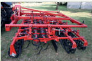
Kombi-Mix magágykészítők 2,8-tól 5,6 m munkaszélességig, robosztus kivitel.
