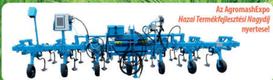
Kamerával figyelt, elektrohidraulikusan vezérelt sorközműelő kultivátor
