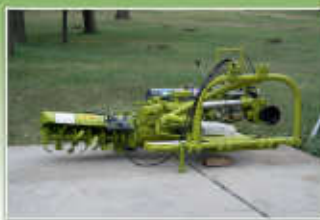
Calderoni FPS oldalsó talajmaró gyűmölcsösbe. Maximális kinyúlás traktorközéptől 310 cm.
