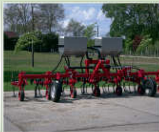
Calderoni FPS oldalsó talajmaró gyűmölcsösbe. Maximális kinyúlás traktorközéptől 310 cm.
