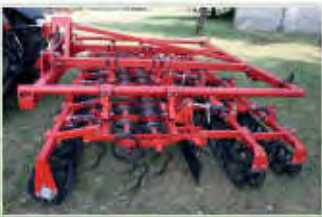
Kombi-Mix magágykészítők 2,8-tól 5,6 m munkaszélességgel, robosztus kivitel.
