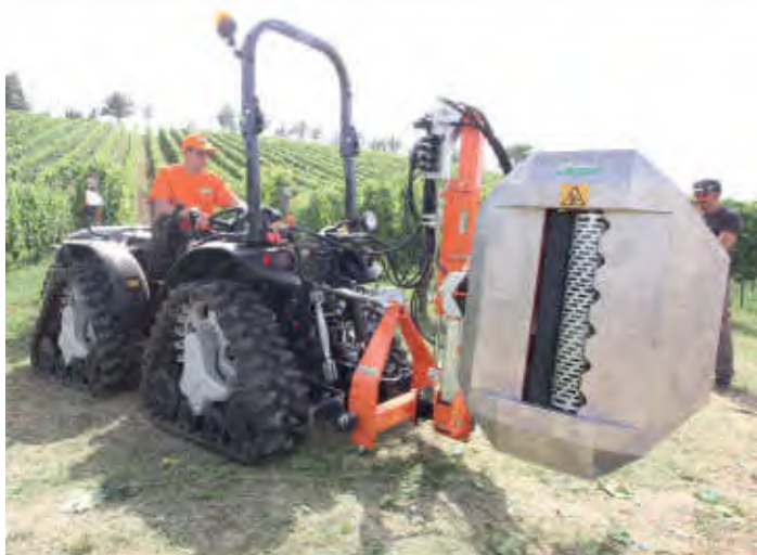
RINIERI DRF ablakoló berendezés. 180°-ban fordítható, önálló vázszerkezettel
