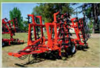
SA ásóboronák 1,8-tól 8,4 m munkaszélességgel, 3 sor késtengellyel, 2 sor törőhengerrel, bóracél ásókésekkel, öntvény csapággal szerelve.
