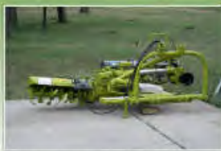
Calderoni FPS oldalazó talajmaró gyűmölcsösbe. Maximális kinyúlás traktorközéptől 310 cm.
