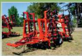
SA ásóboronák 1,8-tól 8,4 m munkaszélességig, 3 sor késtengellyel, 2 sor törőhengerrel, bőrácél ásókésekkel, öntvény csapággal szerelve.
