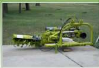
Calderoni FPS oldalazó talajmaró gyűmölcsösbe. Maximális kinyúlás traktorközéptől 310 cm.
