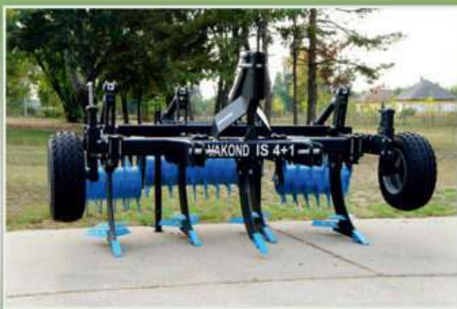
Vakond középmezőművelők 2–5 késes kivitelben, tüskés elmunkáló hengerrel.
