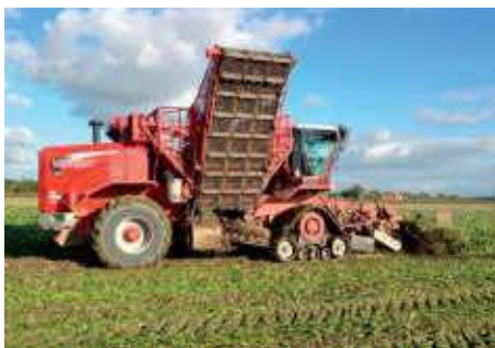
↑ Vervaet cukorrépakombájra szerelt gumihevederes járószerkezet
