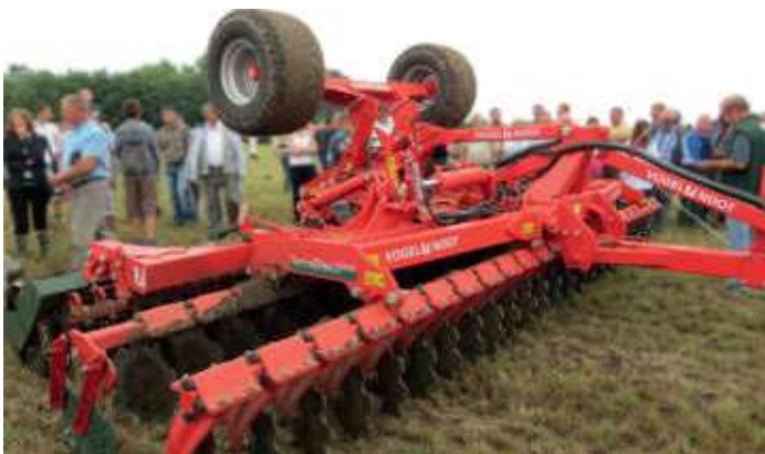
↑ Agresszív szögállású csipkézett tárcsák
