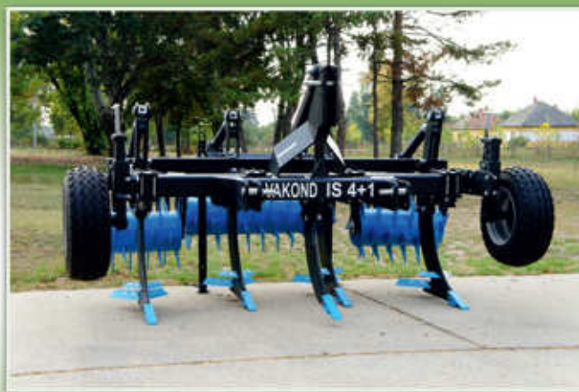
Vakond középmedyművelők 2-5 keses kivitelben, tuskés elmunkáló hengerrel.
