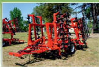
SA ásóboronák 1,8-tól 8,4 m munkaszélességig, 3 sor késtengellyel, 2 sor törőhengerrel, bórácél ásókésekkel, öntvény csapággal szerelve.
