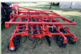
Kombi-Mix magágykészítők 2,8-tól 5,6 m munkaszélességig, robosztus kivitel.
