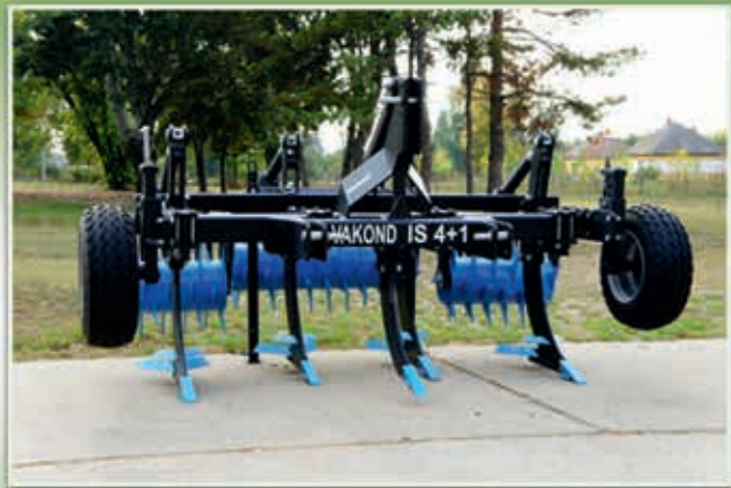
Vakond középmélyművelők 2–5 késes kivitelben, tüskés elmunkáló hengerrel.
