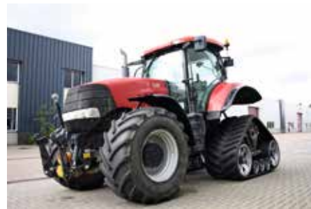
5. kép: HST nagy sebességű gumiheveder hátsó tengelyen
