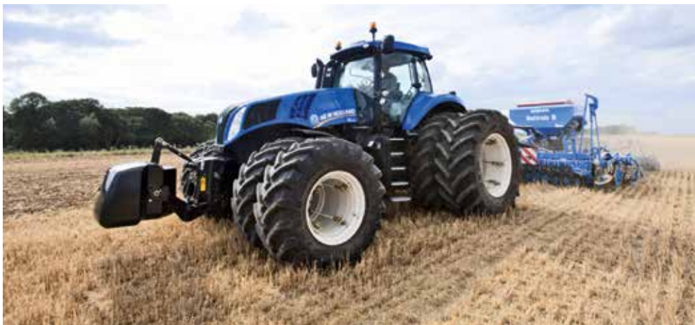
1. kép: Ikerkerekekkel szerelt nehéz univerzális traktor
