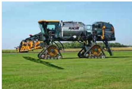
4. kép: Gumihevederes járszerkezetű önjáró permetezőgép
