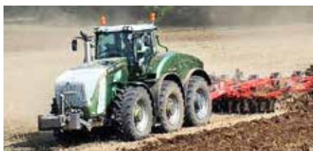
2. kép: 3 tengelyes Fendt Trisix Vario traktor
