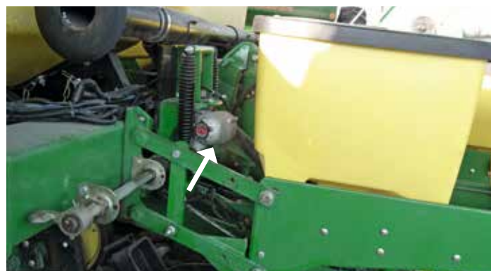
A mélységszabályozó hidraulikus motor a vetőkocsin
