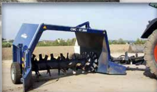
önjáró és traktorvontatású komposztforgató berendezések
