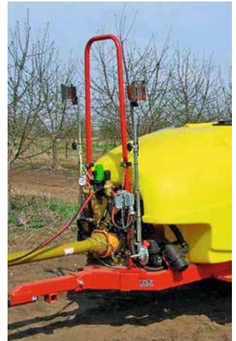
3. kép: Infravörös növényérzékelővel felszerelt permetezőgép (saját kép)
