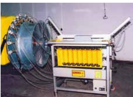
2. kép: Ültetvény permetezőgép szórófejeinek ellenőrzése (saját kép)
