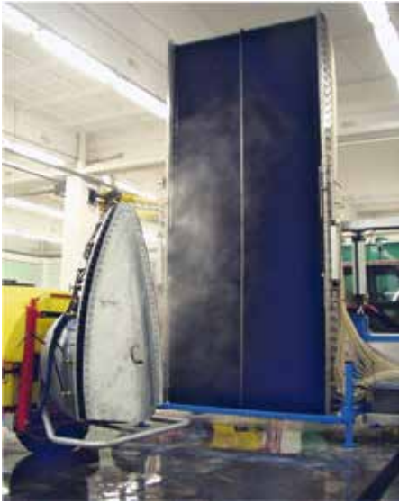
1. kép: A permetlé függőleges síkban történő eloszlásának mérése (saját kép)
