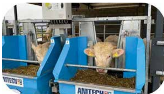
Az RFI (takarmány-visszahagyás) mérésére szolgáló RIC (napi egyedi takarmánykeverék-felvételt mérő) rendszer a MATE Kaposvári Campusán
