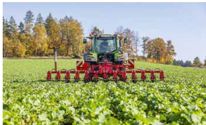
Transformer – Repce sorközművelés
