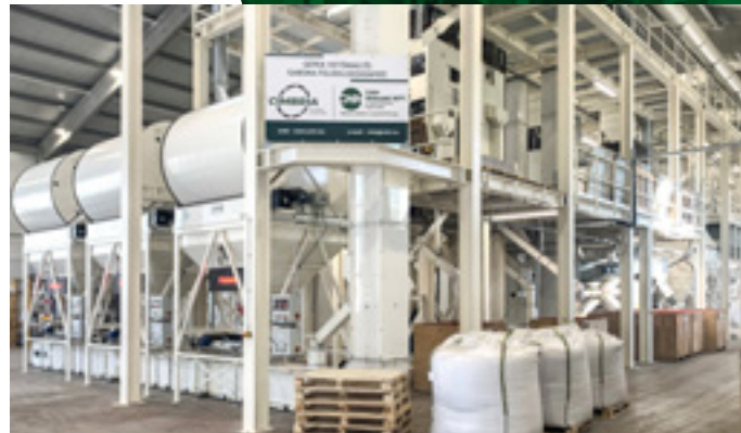
Hibrid kukorica feldolgozóüzem. A 2. szinten egy 12 T/h-ás színosztályozógép dolgozik, fő feladata a sűrűlt, fertőzött és a fajtaidegen magok eltávolítása
