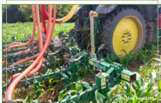
A Fertitronic szenzor és egy Garford sorközművelő kultivátor a gyakorlatban, kukoricakultúrában
