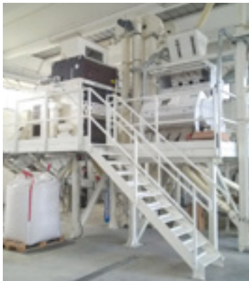
A színosztályozógép az utolsó osztályozógép a technológiai sorban. Vetőmagüzemben vagy élelmiszerfeldolgozásnál elengedhetetlen
