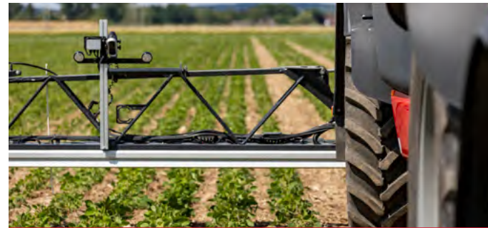
Sávpermetezés – kamera által kormányzott Leeb 5 LT
