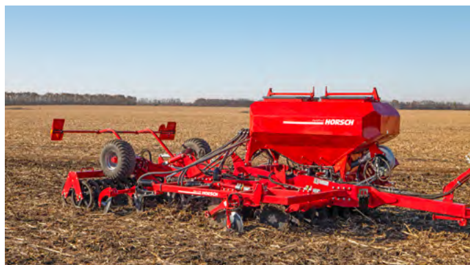
Tiger 4 MT FertiProf – Aprítás–mélyítés–műtrágyázás egy menetben
