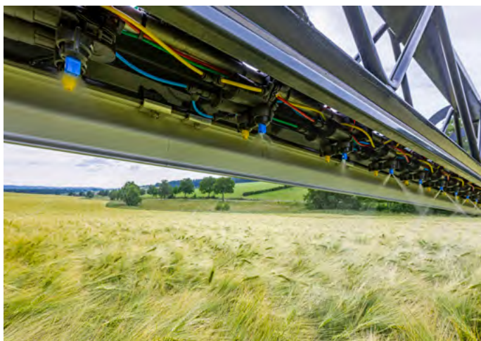
3D permetezés a 25 cm fúvókaosztással
