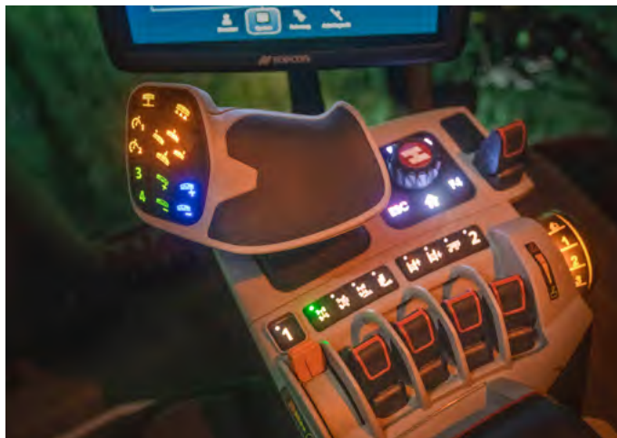
Önjáró permetező ergonomikus karfája – itt minden kézre áll
