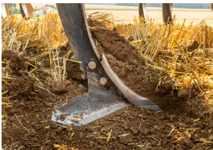
MulchMix kaparendszer-szárnyakkal sekély művelésnél (vagy szárny nélkül a mélyművelésnél)
