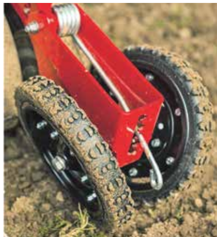
Új típusú zárókerek repce és cukorrépa vetéséhez
