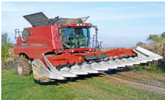
2. ábra: A CASE IH 8120 típusú, 12 soros vágóasztallal és hozammérő rendszerrel ellátott kombájn
