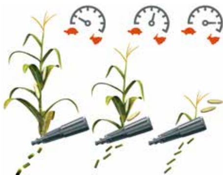
Kúpos törőhenger munkája az egyes pontokon
