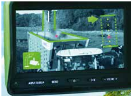
Szállító jármű körvonalainak folyamatos vizsgálata a kifúvótoronyra szerelt kamerával
