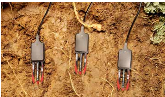
2. ábra: a Decagon cég kombinált talajszenzora
