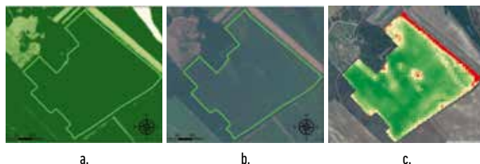
2. ábra: a július végén műholdas távérzékeléssel készült vegetációs index kép (a), látható fény tartományú felvétel (b), valamint a helyesen értelmezett műholdkép interpretáció (A műholdkép elemzést az AgriDron Kft. készítette)
