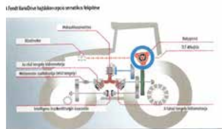
A Fendt 1000 traktorok TA 400 Vario sebességváltójának működési sémája
