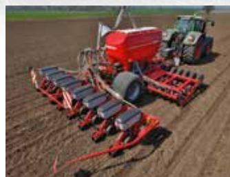
Pronto 6 AS PPF és Maestro 8 RC: a vetőmag mellett kétféle műtrágya plusz mikrogránulátum kijuttatása egy menetben
