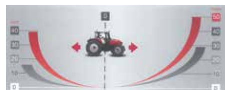
A Massey Ferguson Dyna VT sebességdiagramja
