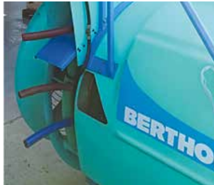
5. ábra: a folyadékadagolás ellenőrzéséhez a szórófejekre tömlőket illesztünk
