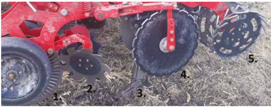
1. ábra: sávművelő eszköz általános felépítése (fényképezte: Bényi Ferenc)
