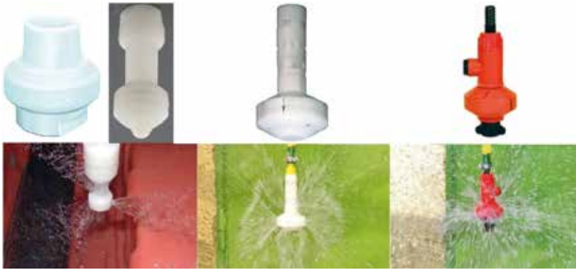
2. ábra: méréseknél használt szórófejek (Teejet, Lechler, POLMAC, ARAG)
