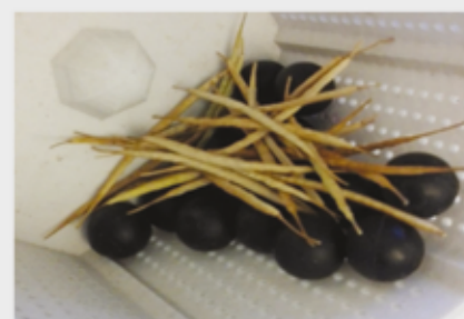
Rázóteszt: gumilabdákkal töltött edényben rázták a becőket, majd számozták a kipergett szemeket.
