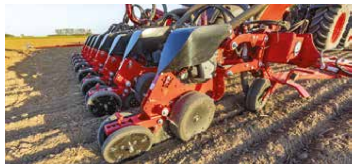
Maestro robusztus paralelogramma, hidraulikus AF csoroszyanyomás állítás
