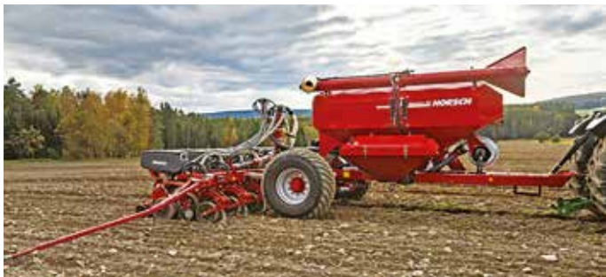
Maestro 8 DV osztott 3500 l műtrágyatartály, 300 l mikrogranulátum tartály
