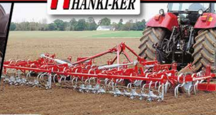
Kongskilde Vibro Master SQ, SGC könnyű vázas magágykészítő kombinátorok
