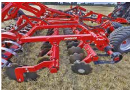
A párosával szerelt tártsalevelek, robusztus csapágyakkal, nagy átömlő keresztmetszettel
