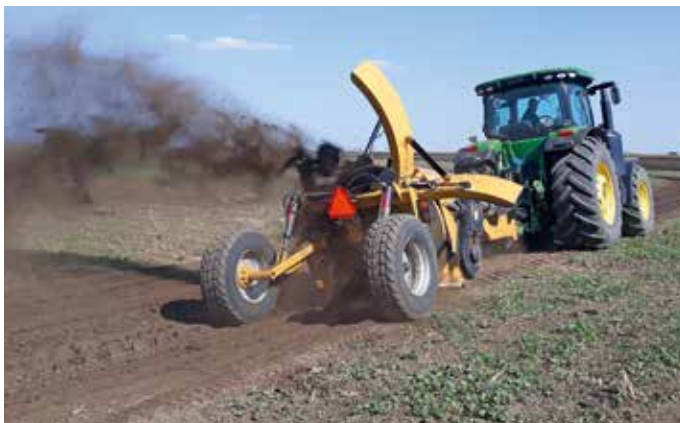
Vápanyítás Wolverine vápanyítóval, JD iGrade szintezésvézelővel
