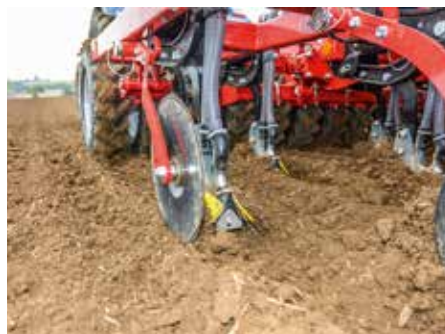
Sprinter vetés: a műtrágya a vetett sávok közé-alá kerül
