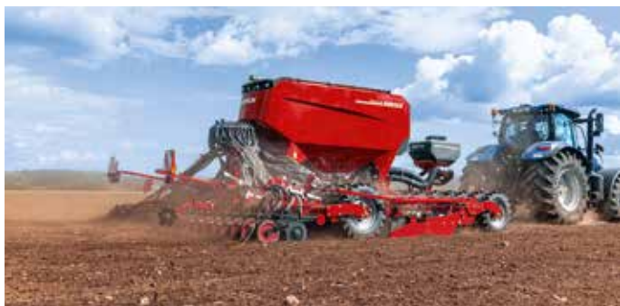
A Pronto 6 DC talajt művel – egyenget, tömörít, vet, lezár
