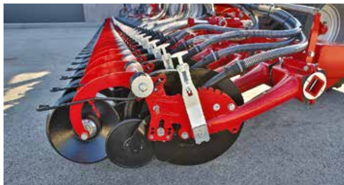
Avatar egytárcsás csoroszlya magfogó és tömörítő kerékekkel
