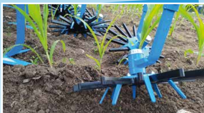
Nagyon közel dolgoznak az ujjas/csillagkerekű kapák a haszonnövényhez, így a lehető legpontosabb a gyomszabályozás
