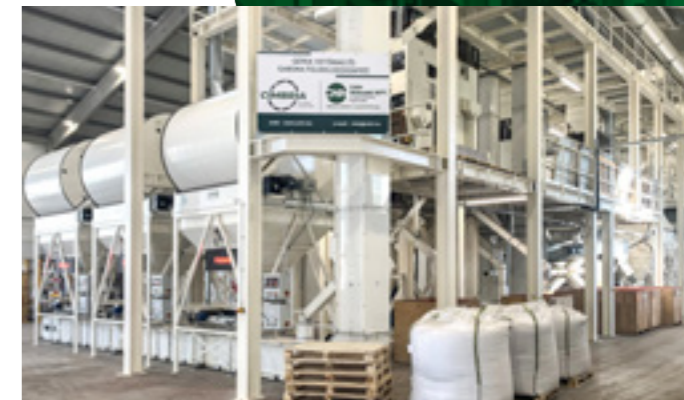
Hibrid kukorica feldolgozóüzem. A 2. szinten egy 12 T/h-ás színosztályozógép dolgozik, fő feladata a sérült, fertőzött és a fajtaidegen magok eltávolítása
