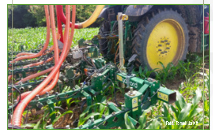
A Fertitronic szenzor és egy Garford sorközművelő kultivátor a gyakorlatban, kukoricakultúrában
