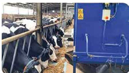
1. ábra: felsőpályás takarmánykiosztó robot (Forrás: Húth és Tóth, 2021; Digitális Agrárakadémia)
