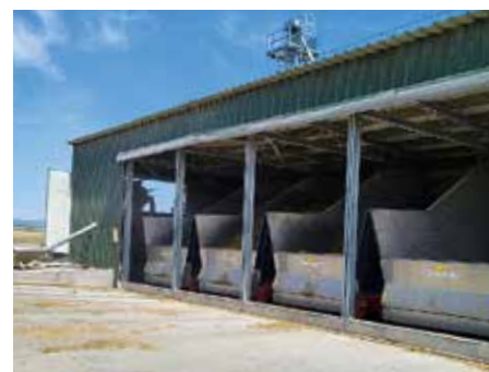
2. ábra: az egyes takarmánykomponensek napi fogadására és tárolására szolgáló asztalok, előtartályok (fotó: Húth és Tóth)
