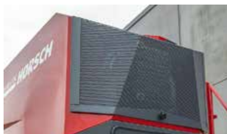
A ventilátor magasabbra és zárt helyre került
