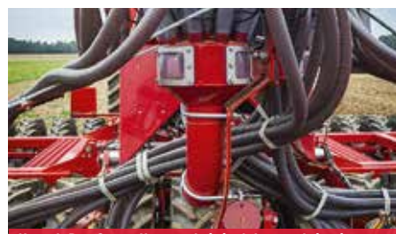
Horsch RowControl – sorlezárások keresztirányú eloszlás torzulás nélkül
