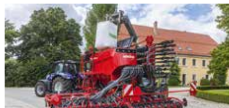
A féloldalassal összecsuksák – rövidebb karú teleszkóppal is könnyedén lehet tankolni
