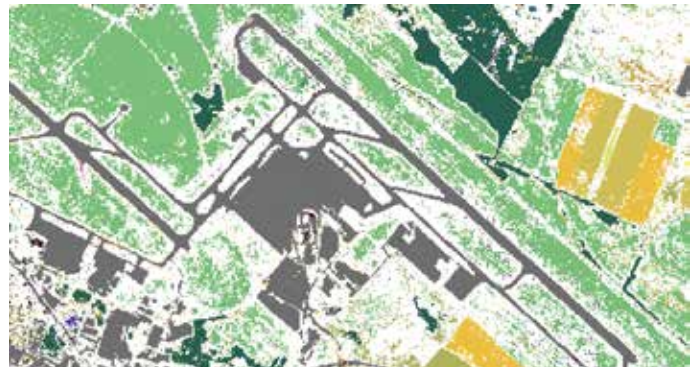
1. ábra: a Sentinel műholdkép alapján készült felszínborítási osztályozó eljárás eredménye
