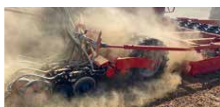
EKS csoroszlya magfogó kerékkel – tökéletes beágyazás
