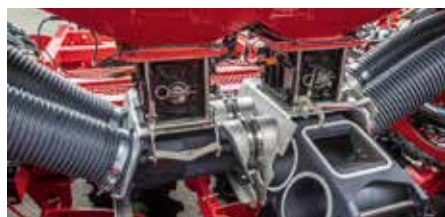
A kazettás adagoló megkönnyíti a leforgatást és a vetőmag-műtrágyatartály cserét
