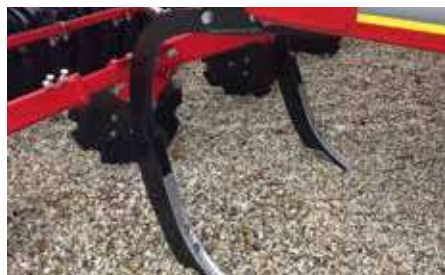
TG kapaartó – LD kapa – lazítás, minimális keverés
