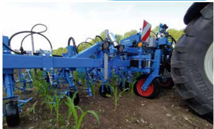
Kamerák, lámpák, kapák és szórófejek is segítik a LEMKEN EC-Weeder gyomirtási munkáját
